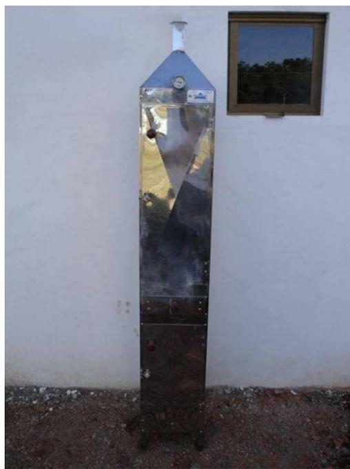
FIGURA 2. DEFUMADOR ARTESANAL COM CAPACIDADE PARA 20KG.
