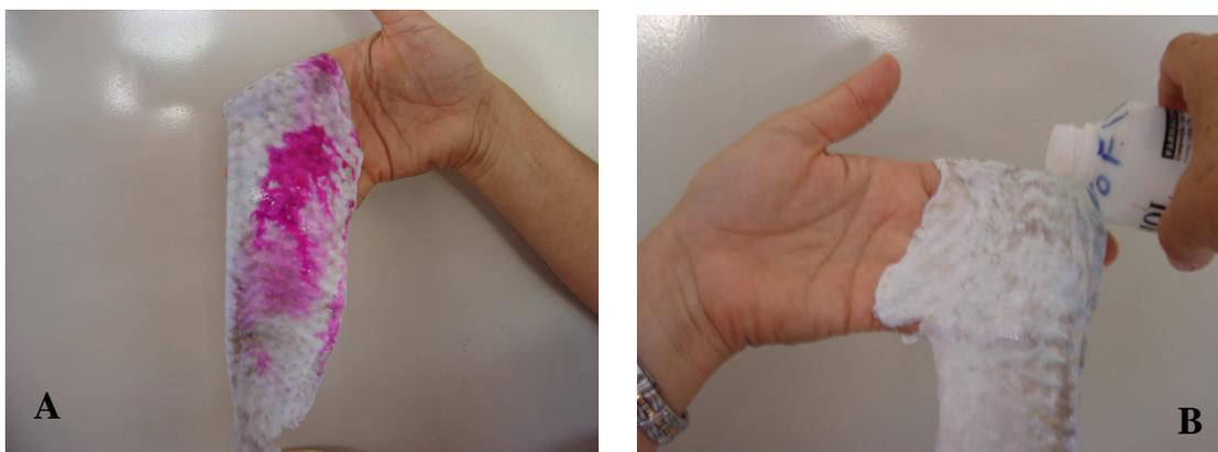
FIGURA 9 – ADIÇÃO DE FENOLFTALEÍNA NA PELE TRIPA DE PEIXE PARA VERIFICAÇÃO DO SEU PH. (A) PELE COM PH ACIMA DE 8,5 E (B) PELE COM PH ABAIXO DE 8,5, COM A ADIÇÃO DE UMA GOTTA DE FENOLFTALEÍNA SOBRE O COURO, ESTE NÃO APRESENTA PIGMENTAÇÃO ROSA
