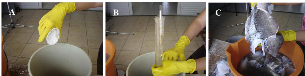
FIGURA 6 – MÉTODO DE CONSERVAÇÃO DE PELE DE PEIXE POR SALMOURAGEM E SALGA. PREPARAR A SOLUÇÃO COM ADIÇÃO DE SAL NA ÁGUA (A), VERIFICAR O GRAU BAUMÉ (B), QUE DEVE SER EM TORNO DE 24°BÉ, DEPOIS COLOCAR AS PELES NA SALMOURAGEM (C)
